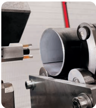
Automatyczne wykrywanie i pozycjonowanie szwów rur
