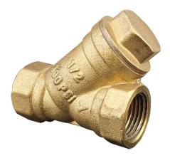
Les filtres en laiton Profit peuvent être utilisées dans les systèmes de tuyauterie sensibles à la présence de débris dans le fluide. Elles filtrent les éléments solides pour protéger d'autres équipements tels que les clapets d'alarme contre tout dommage ou mauvais fonctionnement. Les filtres de type DYST-½ sont dotées d'extrémités filetées femelles. Elles sont conçues de manière à pouvoir être nettoyées sans être retirées du système de tuyauterie.
