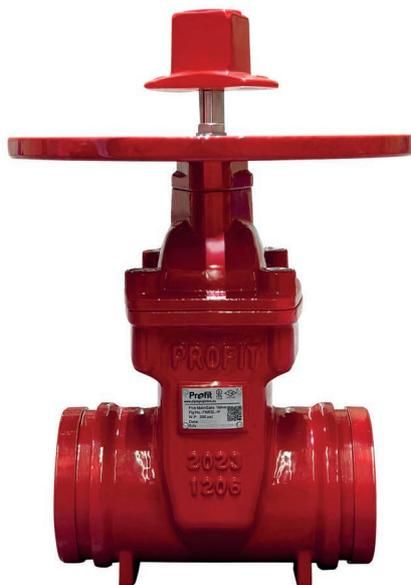
Les robinets-vannes PROFIT de type GNRSL sont des robinets-vannes à siège résilient avec extrémités rainurées et tige fixe, assurant un passage net de 100%. Ils sont généralement utilisés dans les systèmes de protection contre l'incendie comme vanne d'isolement à commande manuelle.
