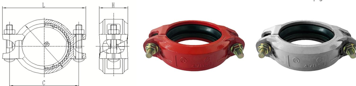
Les raccords angle-pad lourds GKSH assurent un raccordement entièrement rigide des tuyaux et/ou des raccords rainurés. Le raccord a été conçu pour obtenir une rigidité angulaire et axiale en se fixant fermement dans la base de la rainure. Les petites bosses internes offrent une résistance à la torsion et les pattes de fixation angulaires garantissent la rigidité dans toutes les conditions de tuyaux et de rainures.
