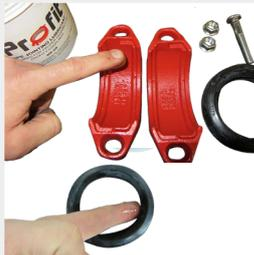
**5** Glisser le joint sur l'extrémité du tuyau, de sorte qu'il la couvre entièrement.
