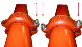
**10** Serrer alternativement les boulons avec une clé à chocs avec une douille adaptée jusqu'à ce que le raccord soit entièrement fermé. Toujours observer les couples de serrage des boulons pour obtenir une bonne étanchéité (voir le tableau). Un couple de serrage trop important n'améliore pas l'étanchéité du raccord. Au contraire, il peut endommager les boulons et/ou boîtiers et peut même être la cause d'une rupture des tuyaux. Un couple de serrage trop petit entraînera des fuites.
